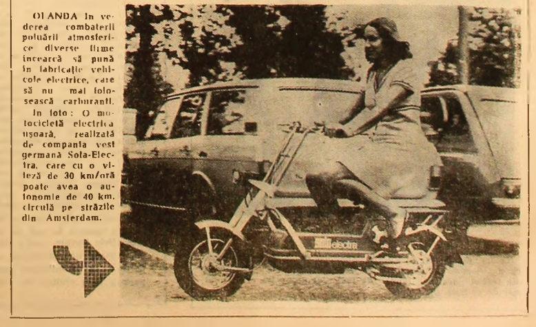
OIANDA In vederea combaterii poluării atmosferice diverse firme încearcă să pună în fabricație vehicule electrice, care să nu mai folosească carburanți. In foto: O motocicletă electrică ușoară, realizată de compania vest germană Sola-Electra, care cu o viteză de 30 km/oră poate avea o autonomie de 40 km. Circulă pe străzile din Amsterdam.
