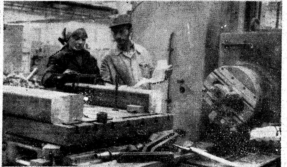
Șeful de brigadă Alexandru Raczek și strungarul Ana Kolbert execută, la o mașină de alezat și frezat din cadrul secției prelucrării mecanice de la IPSRUEEM, un set de piese de schimb pentru o serie de utilaje miniere. Foto: Șt. NEMECSEK
