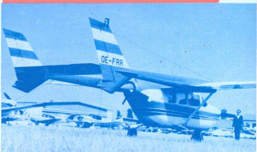
Avionul OE-F.R.R. al concurenților Austriei a trezit interes deosebit datorită construcției sale originale: fuzelaj dublu și două motoare — unul în față iar altul în spate.
