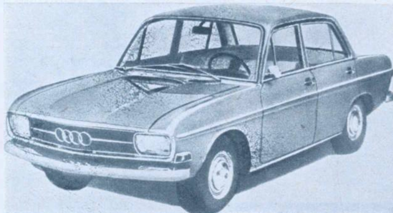
După un sfert de secol de conservatorism, firma DKW a început să renunțe la motorul în doi timpi. Prima tentativă în acest sens a constituit autoturismul Audi construit pe baza vechiului F 102, la care s-a adaptat un motor în patru timpi (Mercedes Benz).
