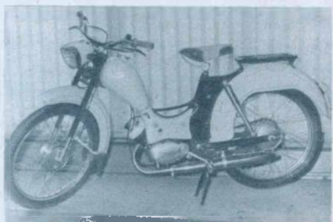
Pe mopedul «Riga 1», fabricat încă din 1962, s-a instalat un motor în doi timpi de 49,8 cmc. El are o putere de 1,5 CP și consumă 1,6 litri de benzină la 100 km (viteză maximă 50 km pe oră).
