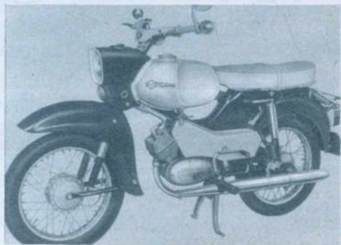
«Sperber» este o motocicletă realizată de constructorii firmei «Simson». Ea dispune de un motor de 50 cmc, în doi timpi, care «scoate» 4,6 CP la 6 750 rot/min. și imprimă o viteză maximă de 75 km pe oră.
