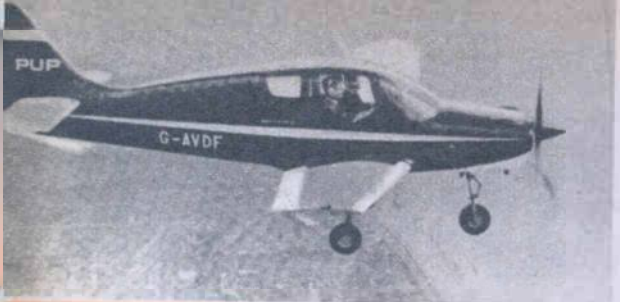
Prototipul micului avion de antrenament și turism «Pup-100» echipat cu un motor de 100 CP.
