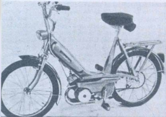
Cady — un model fabricat de Motobécane. Motor de 49 cmc, viteză maximă 33 km pe oră.
