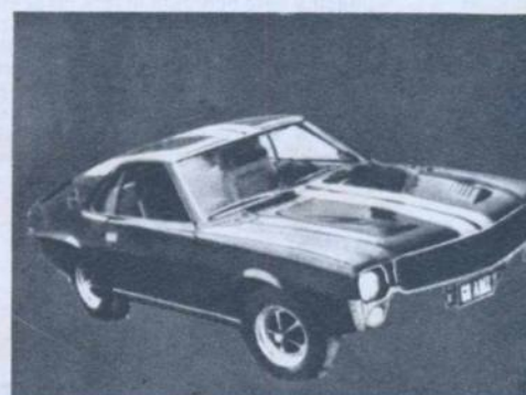
AMX, automobil american de mare cilindree, echipat cu motor V8 de 4753 cmc sau 5622 cmc.
