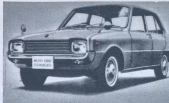
Mazda 1000, o berlină fabricată de Toyo Kogyo, cu motor de 787 cmc. Cei 58 CP imprimă mașinii până la 135 km pe oră.
