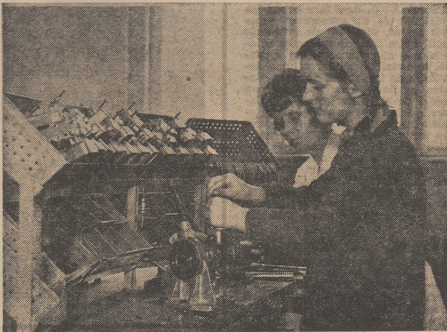
Practică în atelier : asamblarea pompei de injecție
