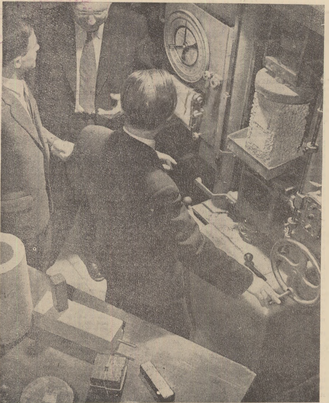
Intr-un institut de cercetare științifică; se încearcă rezistența unor noi materiale de construcții.
