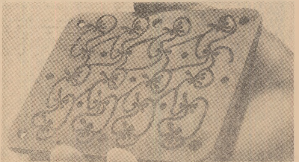
Un labirint de canale sinuoase care seamănă mai degrabă cu o broderie fină. Așa arată plăcile din care se assemblează aparatele pneumonice.
