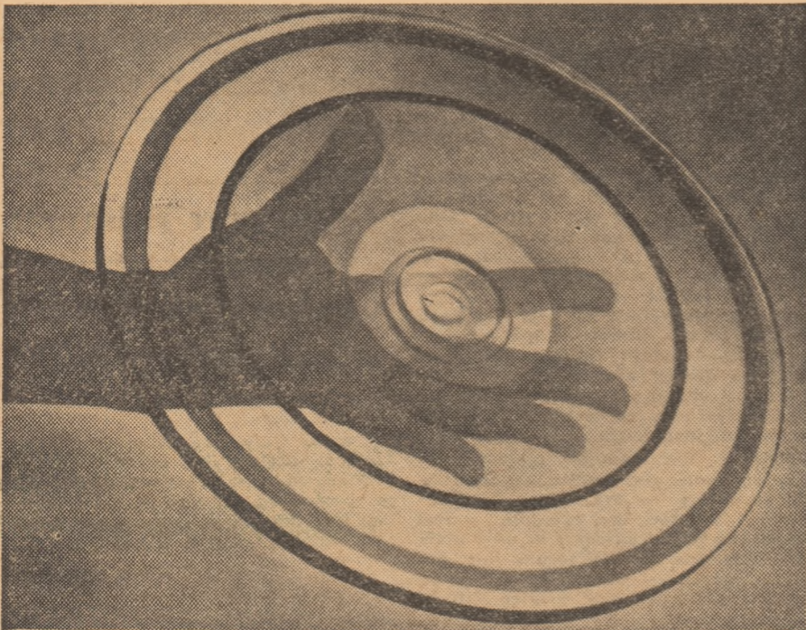
Memoria „totoscopică”. Pe un disc de sticlă, informațiile sînt înregistrate pe linii microscopice în spirală strînsă
