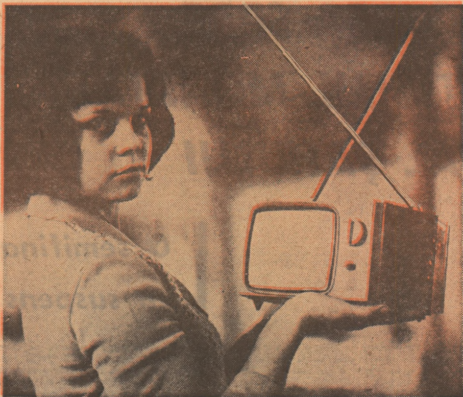
Mini-televizorul „Politehnic” construit la Lvov cîntărește 5,2 kg și funcționează cuplat la rețeaua electrică și cu baterie
