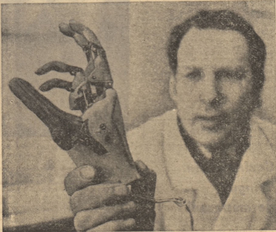
În proiect: mina artificială care-și mișcă degetele independent unul de celălalt
